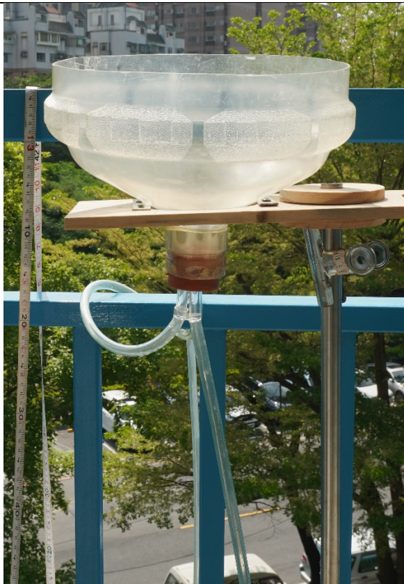
四樓 13 公尺高噴水接盤
